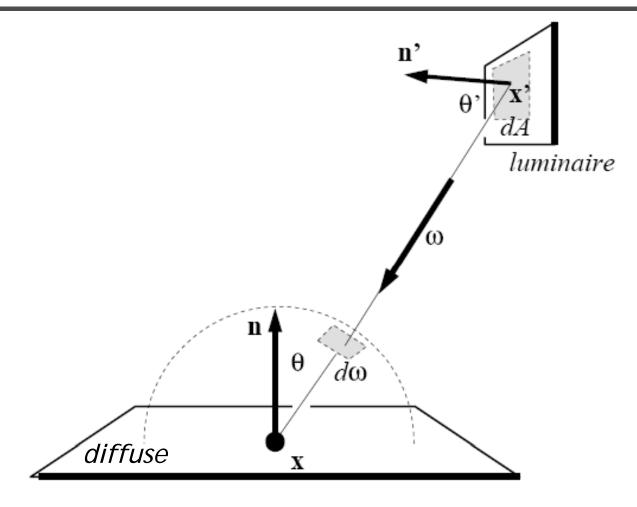
$$L(x) = L_e(x) + \frac{R(x)}{\pi} \int_{\text{all }\vec{\omega}'} L_e(x, \vec{\omega}') \cos \theta \, d\vec{\omega}'$$
