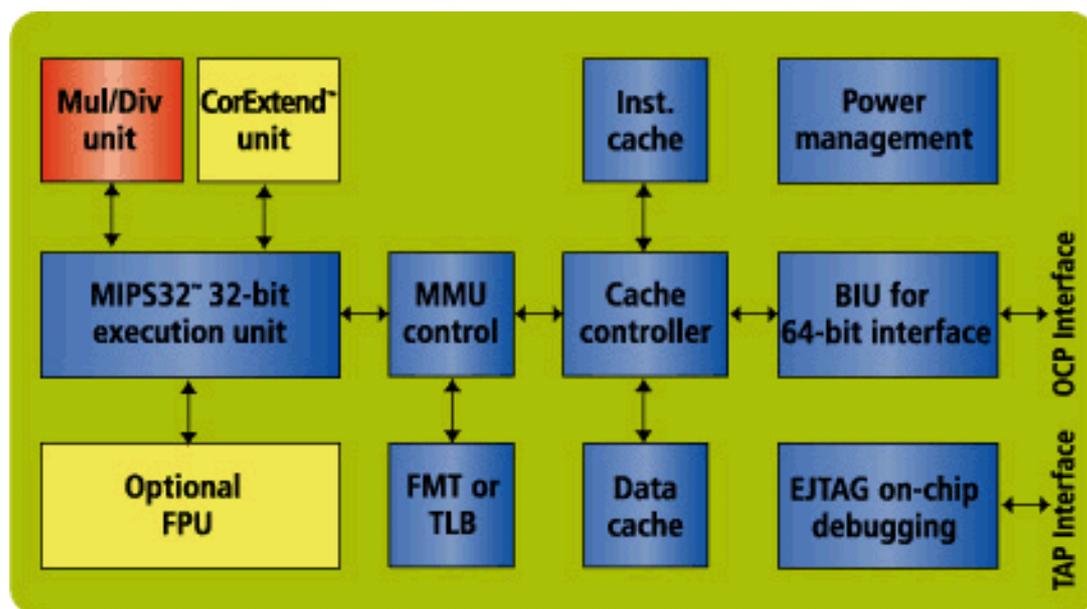
MIPS 處理器是個以管線方式工作的處理器，因此執行程式碼的速度，就相當依賴管線的工作方式。絕大多數 MIPS 指令需要在管線 RD 階段取得足夠的 operands，並且在緊接著 ALU 階段之後產生結果。由於 MIPS 架構中，大多數的指令皆能遵照這樣的運作方式進行處理，因此在指令處理效率上幾乎都能夠達到理論上的最大值。
